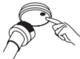
Après installation et suite à une absence prolongée vérifiez le bon fonctionnement du ou des détecteurs de fumée en utilisant le bouton test.
