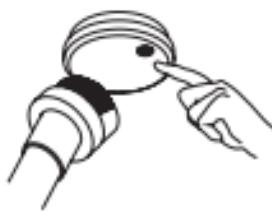
Reinig regelmatig uw detector om de ophoping van stof te vermijden. Dit kunt u met een stofzuiger met borstelkop doen. Doe dit voorzichtig rond het gedeelte vooraan en bij het rooster. Gebruik nooit water, reinigingsmiddelen of oplosmiddelen omdat deze de rookdetector kunnen beschadigen.
